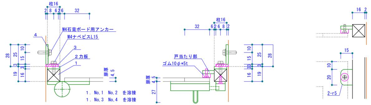
吊り元側柱詳細平面図
