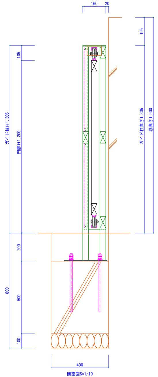
引き戸を閉め、フランス落としを落とす。フランス落としに南京錠を施錠します。上記により通用門の受け側を固定し、利用する。
